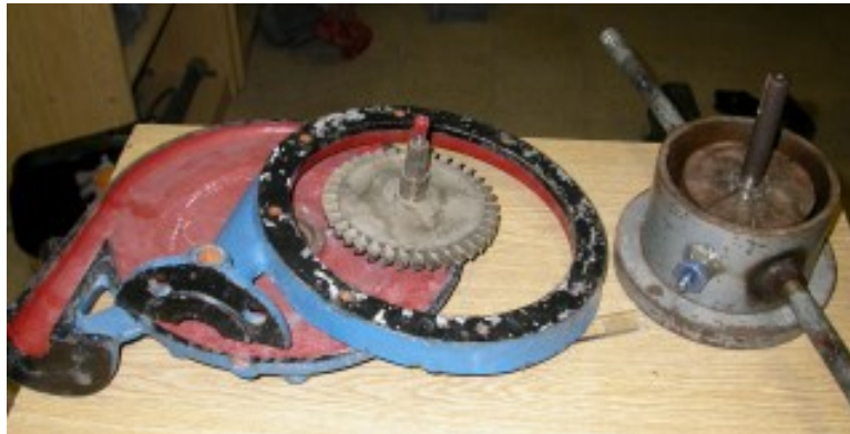
Santrifuj Pompa Çarkı ve Paletli Pompa
