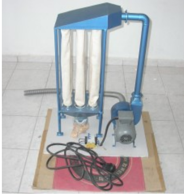
Bez Filtrelerle Talaş Toplama (Öğrenci Projesi)
